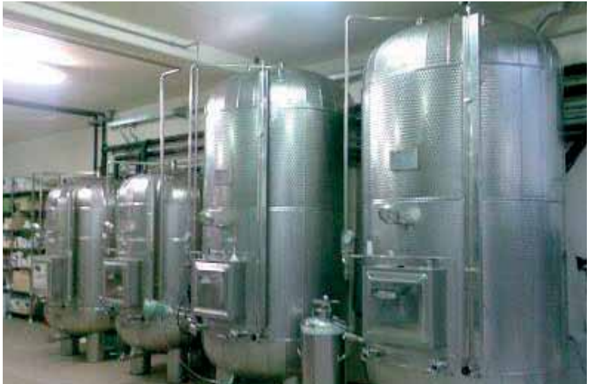
Figura 7. Autoclavi per spumantizzazione
